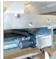
2 Système pneumatique pour la conicité de la butée arrière
