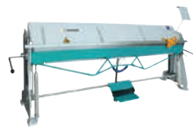
Plieuses PVXPN avec assistance pneumatique 2 et 3 M - Acier 1 à 1,2 mm
